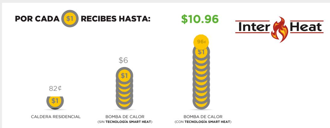
El COP (Coeficiente de eficiencia) más alto es el de la bomba de Calor Inter Heat debido a la incorporación la **Tecnología Inter Heat Smart**, logrando un COP de hasta 10.8, mientras que una bomba de calor convencional es de 6 y una caldera residencial es de .82 solamente.
