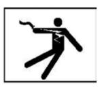
ADVERTENCIA - Para evitar el peligro de descarga eléctrica peligrosa o fatal, APAGUE la energía del motor antes de drenar la bomba. No desconectar la energía puede resultar en lesiones personales graves o la muerte. 1. Drene el nivel del agua por debajo de todas las entradas de la piscina.
